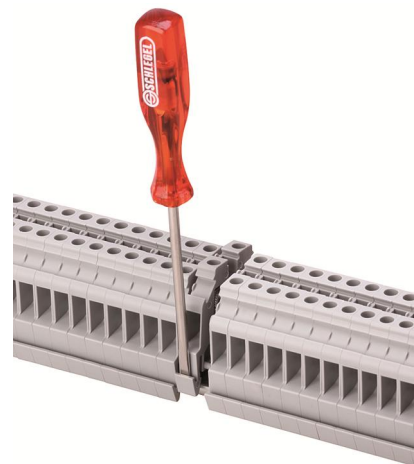
10b. Aufrasten von vormontierten Blöcken. Wichtig: Nach dem Aufrasten der Klemmen sind die Rastfüße der Klemme wieder entlastet. Der Kunststoff kann daher nicht ermüden
