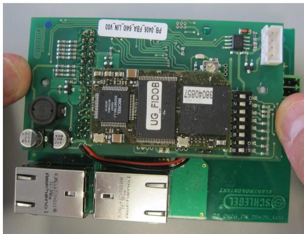
Durch gleichmäßiges Anpressen die Feldbuseinheit auf die Rastbolzen aufrasten.
