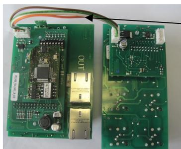
Anschluss für max.15 Erweiterungsmodulen der Type E\_BTKXX\_03(04). Die Verbindungskabel unter den Modulen dürfen eine maximale Länge von 5 Metern nicht überschreiten. Außerdem dürfen die Verbindungskabel eine Gesamtlänge von 30 Meter nicht überschreiten.
