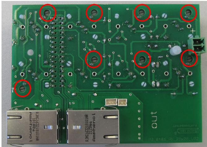
Die Feldbuseinheit abnehmen und die Trägerkarte auf die Betätiger stecken. Anschließend werden die 8 Rastriegel im Uhrzeigersinn gedreht, um die Trägerkarte mit den Betätigern zu verriegeln.
